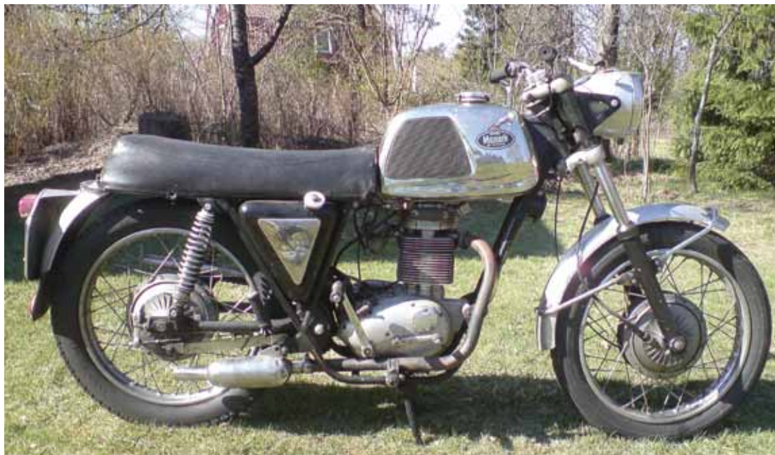
En BSA B25 Fleetstar-motor inbyggd i ett Monark prototyp-chassie. Foto: Thomas Karlsson.
