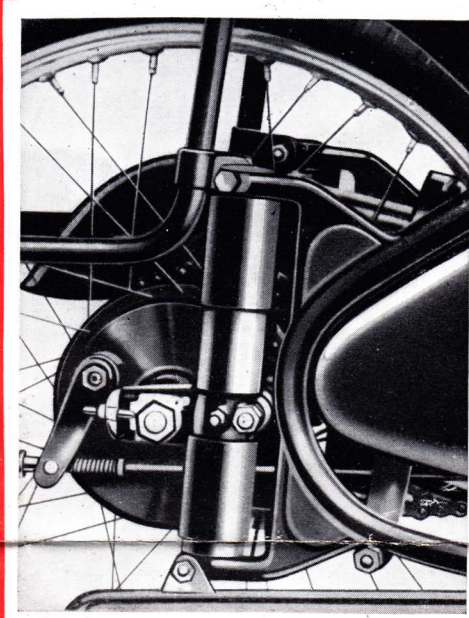
Bakhjulsfjädringen, som kan erhållas för C-modellerna.
