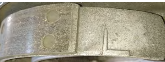
L på bromsbacken anger att denna skall monteras som Leading (ledande).
